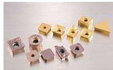
「スーパーZXコート」は、従来のコーティング膜に用いられていた金属元素であるチタンとアルミの量を最適化するとともに、新たにクロムを添加することで、硬度と耐酸化性を大幅に向上させることに成功しました。
