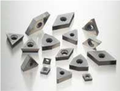
コー ティッドスミボロン®新BNC200は、焼入れ鋼高能率加工用としてご好評いただいているBNC200を全面リニューアルし、さらなる生産性向上、長寿命化を 実現しました。従来品の耐摩耗性を維持しながら耐欠損性を大幅に向上させることにより、焼入れ鋼の浸炭層除去加工（1）等の断続加工による突発的な欠損を 抑制し、従来品に比べ1.5倍以上の工具寿命と高能率加工を実現しています。新BNC200を用いることで製造現場においても、長時間の無人運転が可能と なります。
